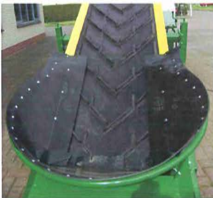
Duurzame rubberband met chevronprofiel (16 of 32 mm) en ronde rubber instortbak
