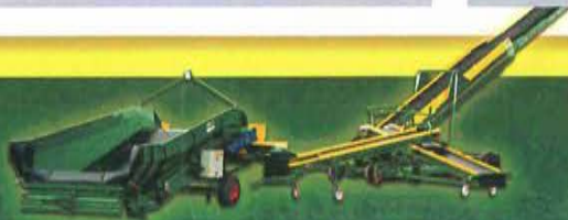
Duurzame rubberband met chevronprofiel (16 of 32 mm) en ronde rubber instortbak
